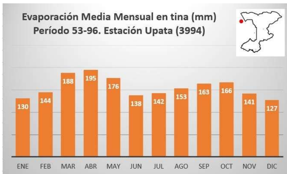
Figura 9.8. Láminas mensuales de Evaporación en Tina, obtenidas de para los años 1953-1996 en la Estación Upata 3994. Promedio anual 1 863.
